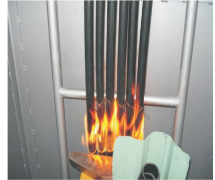
Bó cáp trong điều kiện cháy Bundled cables under fire conditions
